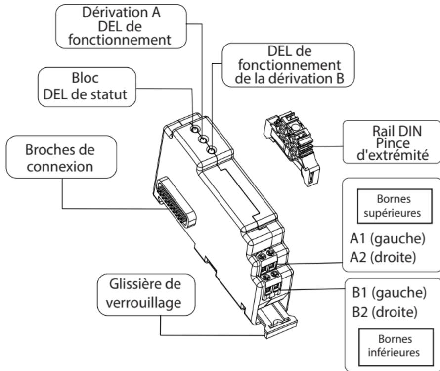
Fixez les blocs au rail DIN à l'aide d'un couvercle, d'une pince ou de tout autre moyen fourni avec le dispositif hôte
