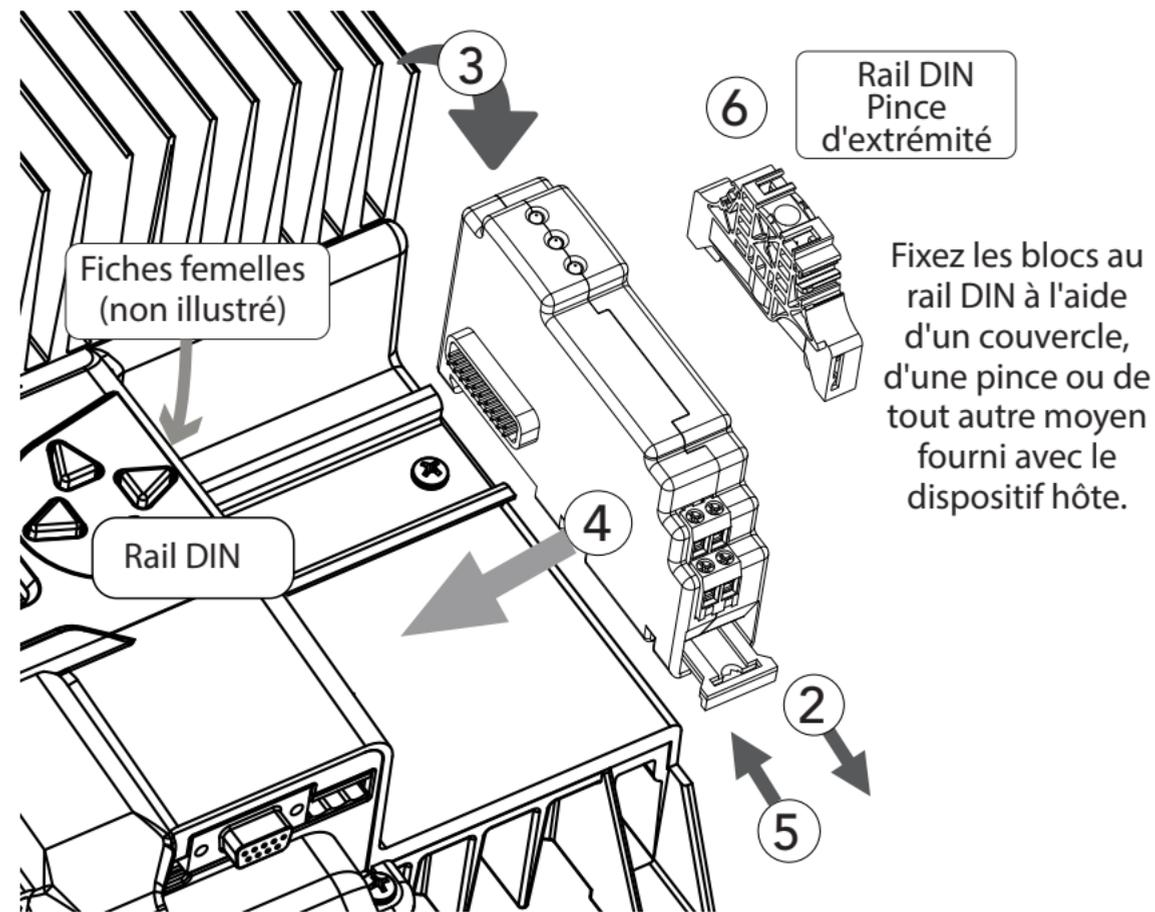
Figure 3-1 - Détails de l'installation du ReadyShunt
